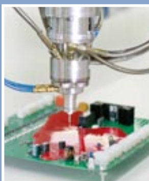
Polyuretán, silikón alebo epoxid chráni citlivé súčiastky automobilu
